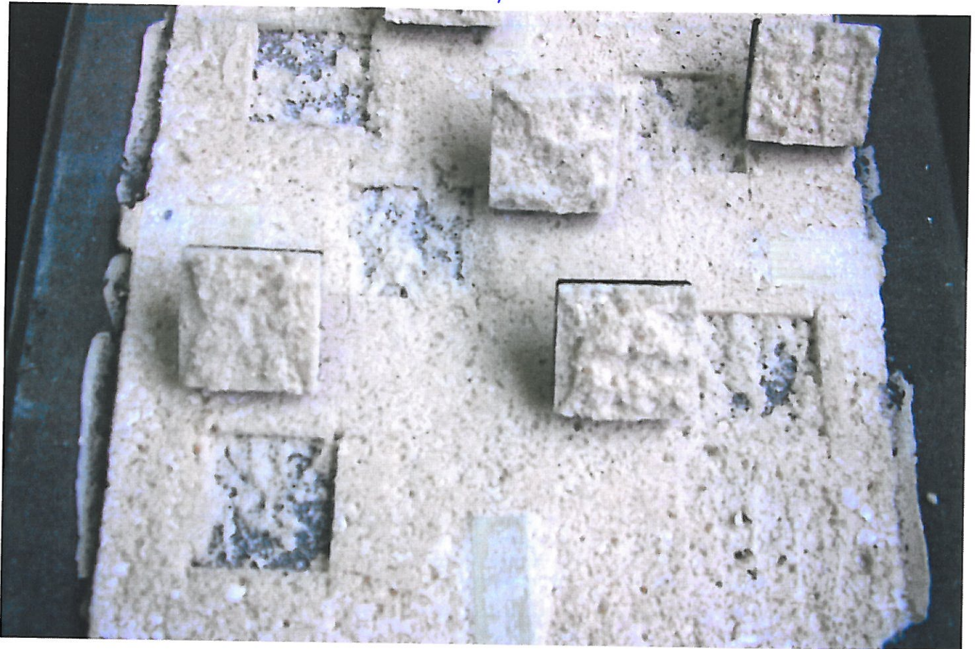
5. zkušební vzorek ( viz. Tab. č. 3 ) po provedení odtrhové zkoušky
