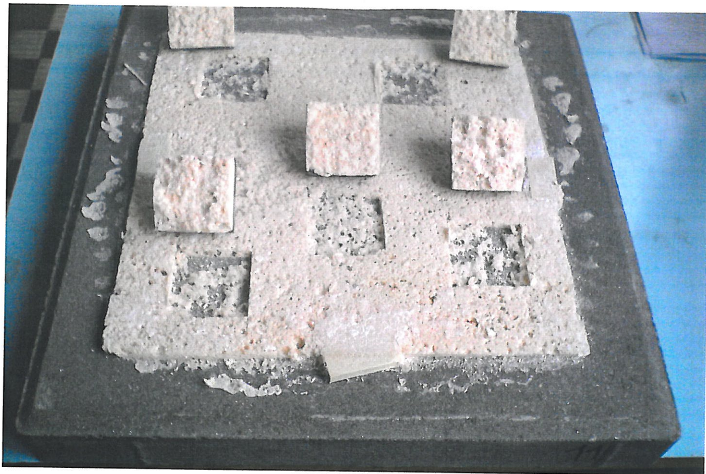
3. zkušební vzorek ( viz. Tab. č. 1 ) po provedení odtrhové zkoušky
