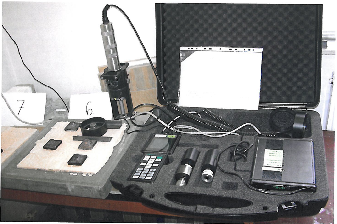
1. odtrhový přístroj COMTEST OP4 před zahájením odtrhových zkoušek PU pěny
