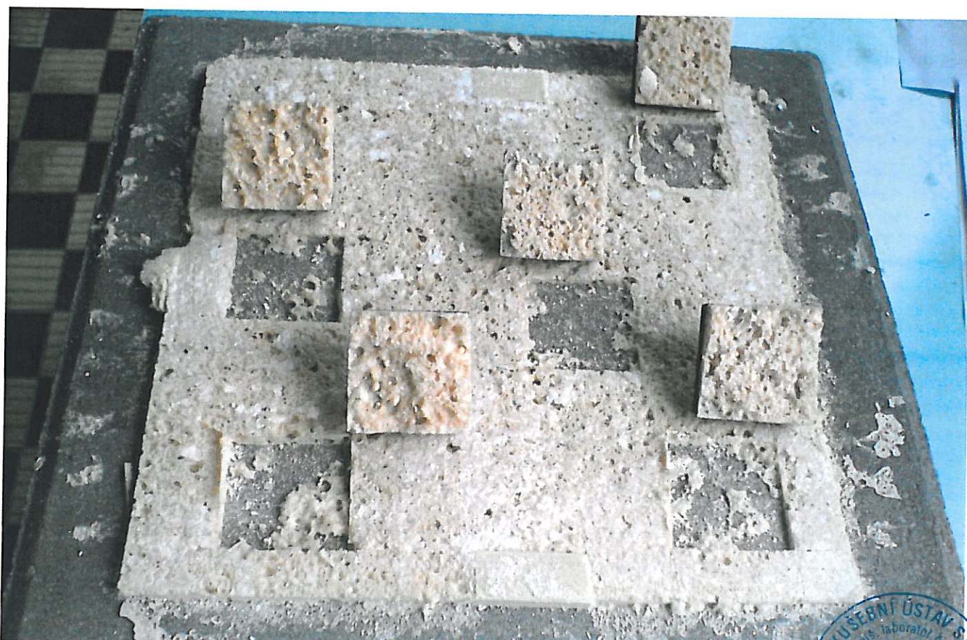
4. zkušební vzorek ( viz. Tab. č. 2 ) po provedení odtrhové zkoušky
